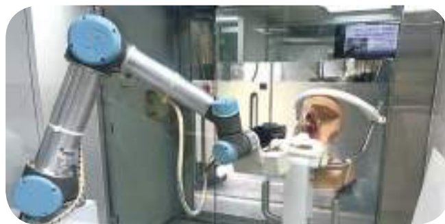
防疫用非接触型コロナウイルス抗体検査所の自動採取ロボット
